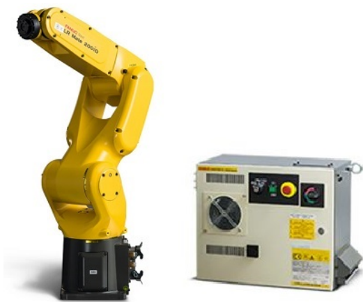
Figura 4: Robô Fanuc modelo LR Mate 200ID [13] à esquerda e o Controlador R-30IB Mate [13] à direita
